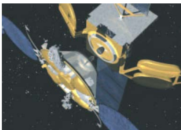
Рис. 6. Стыковка ConeXpress (слева) с клиентским спутником
