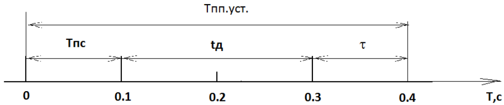
Рис. 2. Цикл работы интеллектуального датчика давления «МЕТРАН-100-ДИ-1051»
